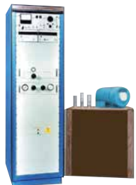
150KVフラッシュX線装置 製造元：米国L3HARRIS
