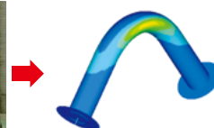
試験を再現した構造解析
