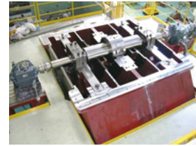
超大型軸受試験機 (max φ 1,000mm)
