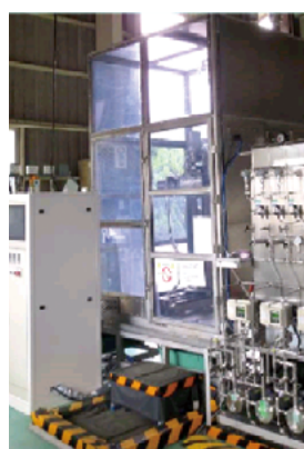
電解加工要素試験装置
